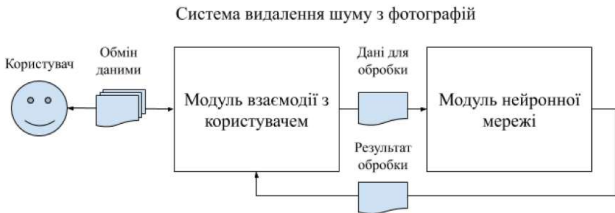
Рис. 2.2 Блок-схема системи видалення шуму з фотографій
