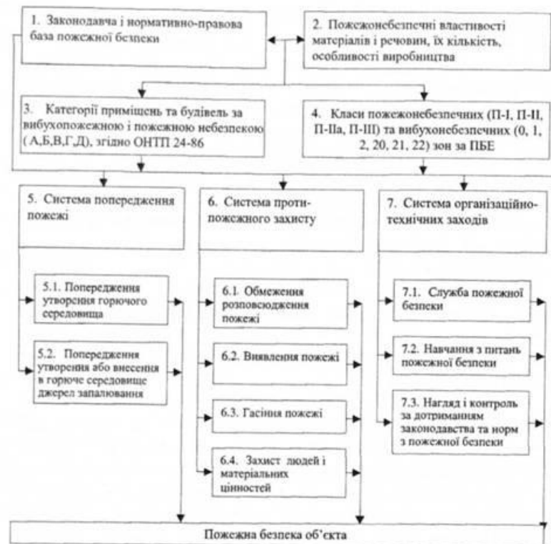
Рис. Б2 Схема комплексу заходів і засобів щодо забезпечення пожежної безпеки в лабораторії
