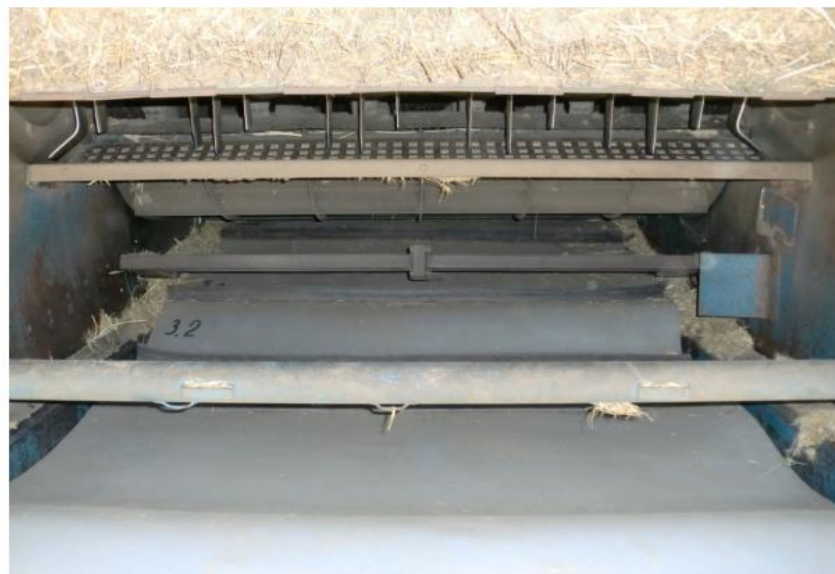
Рис. 2.5. Схематичне зображення пробовідбірника, розташованого під поверхнями сит механічної сортувальної платформи
