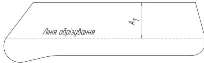
Рис. 2.11. Зображення заготовок носка (а) та леза (б) лемеша плуга
