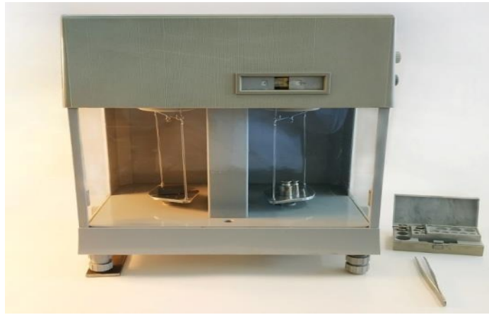
Рис. 2.8 Лабораторні рівноплечі ваги ВЛР-200 г для зважування дослідних зразків
