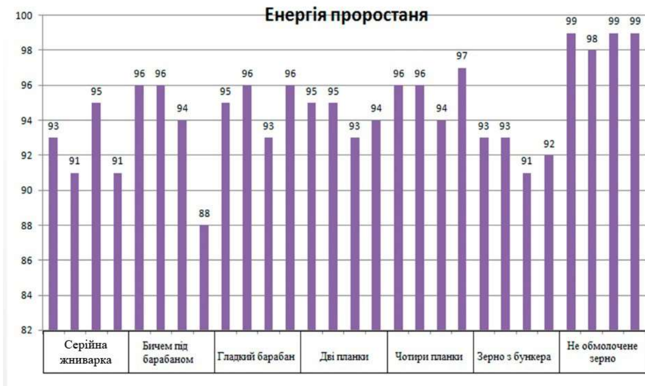
Рисунок. 2.11 – Діаграма результатів дослідження на енергію проростання насіння пшениці, відділеного пристроєм попереднього обмолоту зерна за умов почергового встановлення експериментальних барабанів
