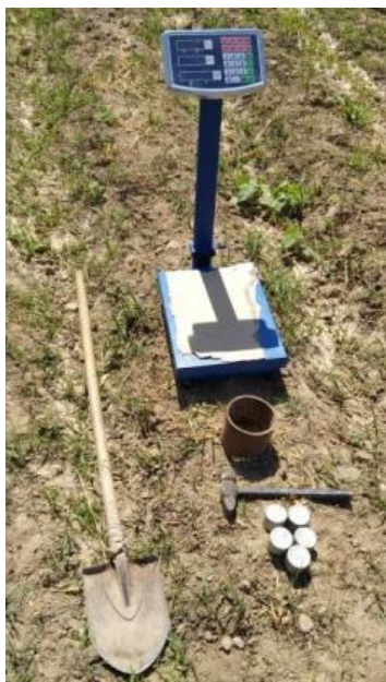
Рисунок 2.20 - Прилади та інструменти для відбору зразків ґрунту щодо визначення його вологості.
