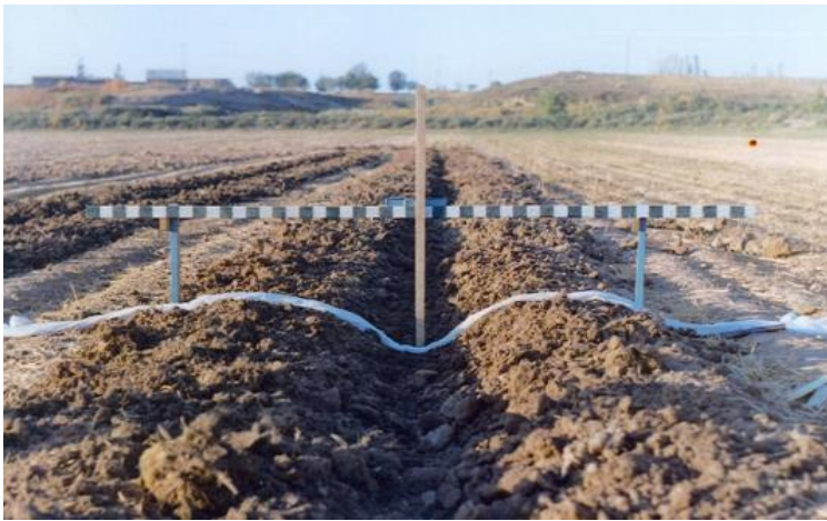
Рисунок 2.43 - Смугова обробка ґрунту під баштанні культури з вимірюванням параметрів профілю борозни без використання розпушувального пристрою.
