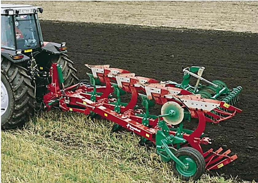
Рисунок 1.15 - Пристрій Kverneland Packomat для підвісного плуга ЕМ /LM Kverneland.
