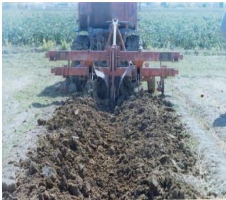
Рисунок 3.1 – Оранка плугом з фронтальними корпусами розташованими полистерної схеми без заплужників, що забезпечує формування поливної борозни.
