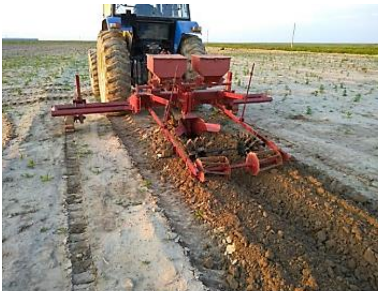
Рисунок 2.47 - Комбінований ґрунтообробний агрегат (КомПА-1,5) у роботі.
