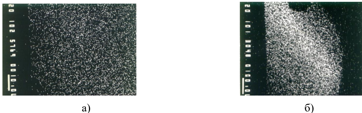
Рис. 3.5 Розподіл концентрації вуглецю в сталі 12ХН3А, поданий у характеристичному рентгенівському випромінюванні: а) – зразок вирізаний з поршневого пальця, відновленого ЕКН і комбінованим спреєрним охолодженням; б) – зразок вирізаний з поршневого пальця, відновленого СВЧ з проточним охолодженням [7]
