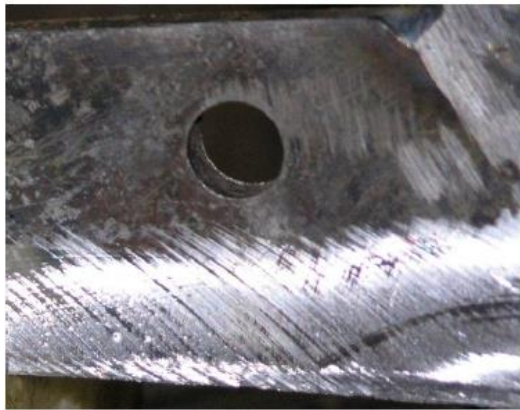
Рисунок 3.7 – Ріжуча кромка плоского ножа дообрізувача гички
