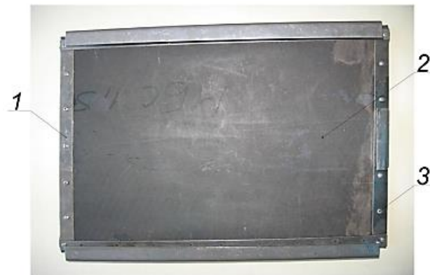
Рисунок 3.7 - Касета з гумовим полотном: 1 – каркас касети; 2 – гумове полотно; 3 – болтові кріплення
