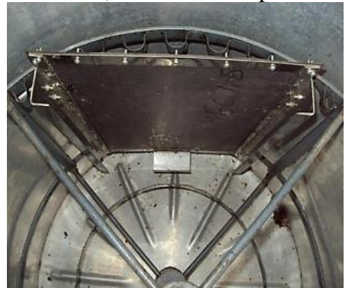
Рисунок 3.8 - Встановлена в роторі касета з гумовим полотном для відцентрової скарифікації пергових стільників.
