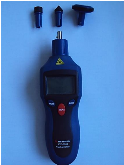
Рисунок 3.5 - Тахометр АКТАКОМ АТЕ-6008
