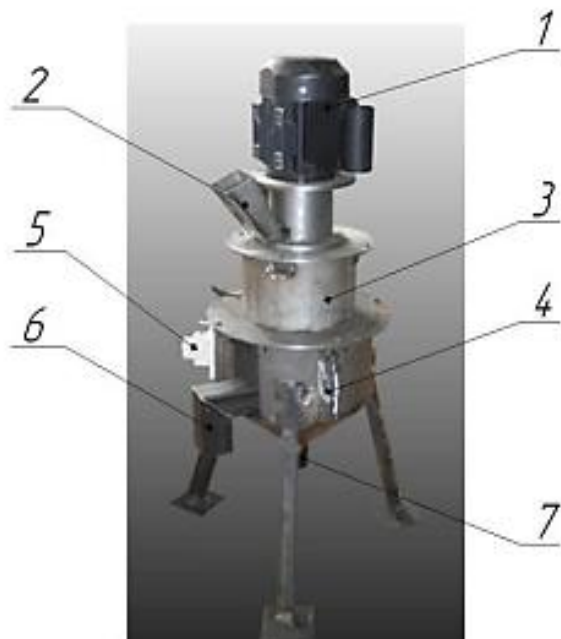
Рисунок 3.12 - Загальний вигляд агрегату АП-30: 1 – електродвигун; 2 – завантажувальна горловина; 3 – подрібнювач; 4 – циклон; 5 - пусковий пристрій; 6 – патрубок для відведення воскової сировини; 7 – вивантажувальний патрубок для гранул перги.
