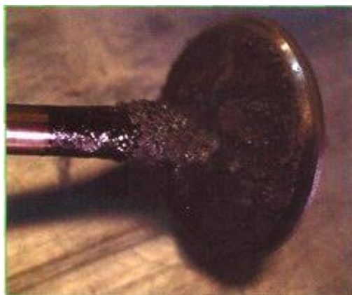
Рисунок 1.5 – Клапан із пошкодженням робочої фаски
