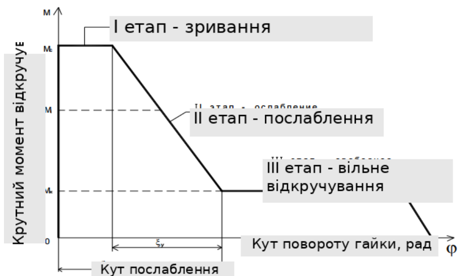
Рисунок 2.1 – Діаграма зміни крутного моменту в процесі відкручування гайки різьбового з'єднання
