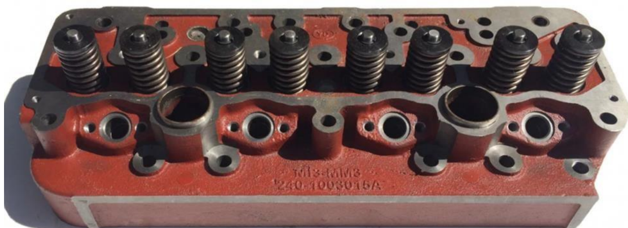
Рисунок 1.3 – Головка блока циліндрів двигуна Д-240
