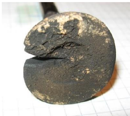
Рисунок 1.6 – Клапан із ознаками термічного пошкодження через перегрів двигуна
