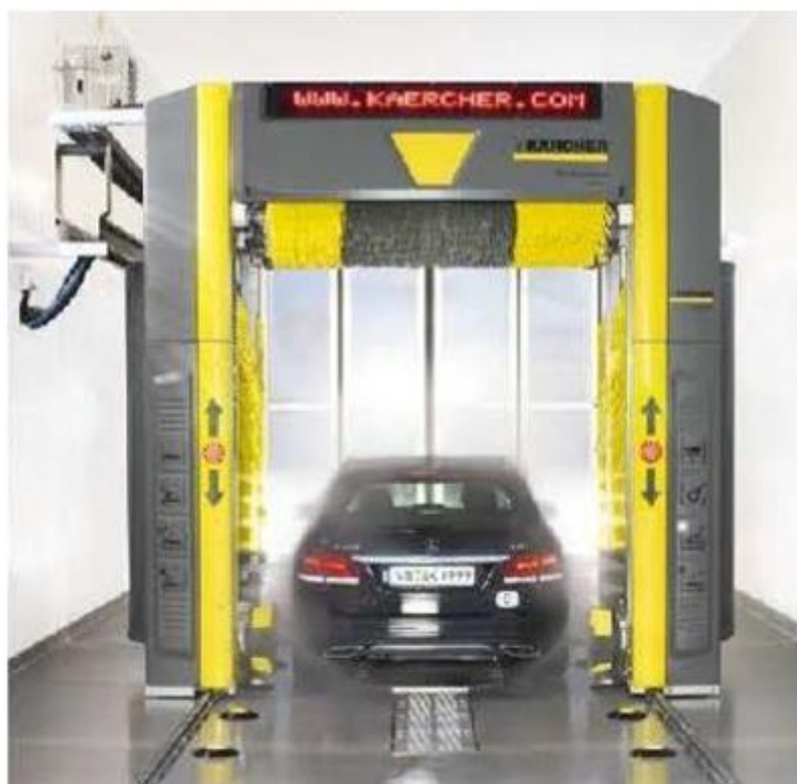
Рисунок 2.3 – Щіткова установка для миття автомобілів
