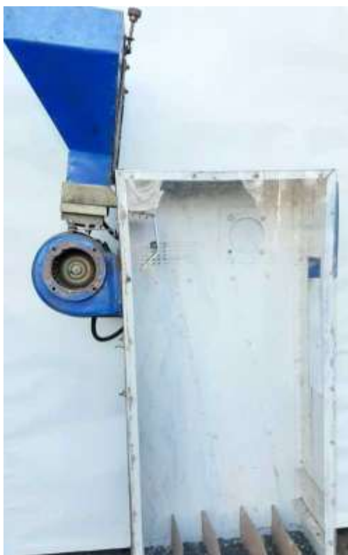
Рисунок 2.9. - Загальний вигляд пневматичного сепаратора для дослідження процесу пневмофракціонування в прямотоці повітря
