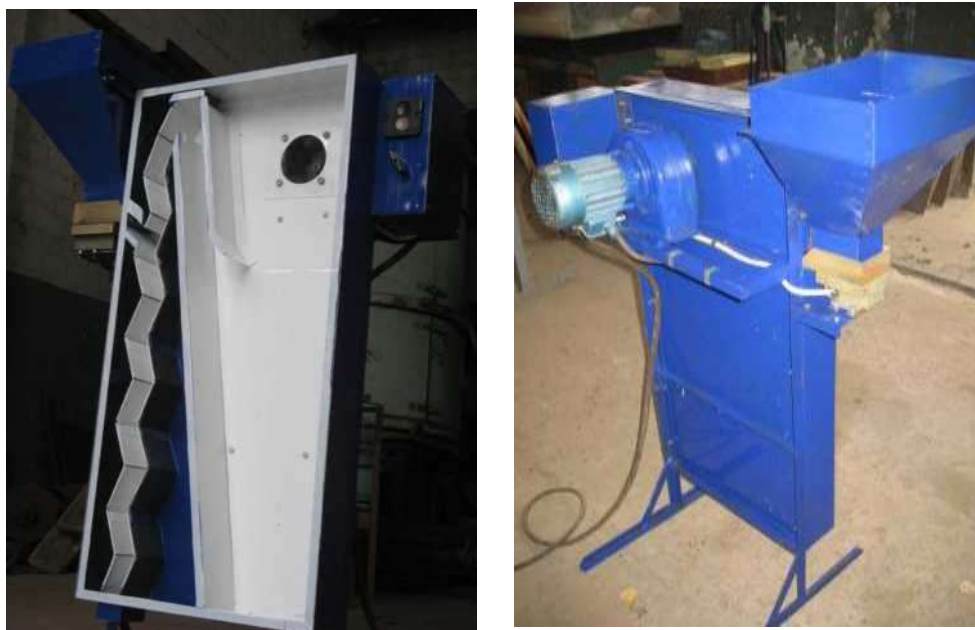
Рисунок 2.8 - Загальний вигляд експериментальної установки пневмофракційного сепаратора ВПС-5М
