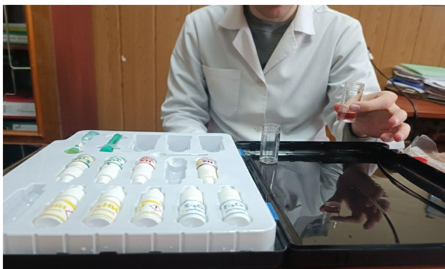
Рис. 3.1. Визначення якості води ставів НДП «Софіївка» експрес-тестом Colombo Aquatest TESTLAB Professional
