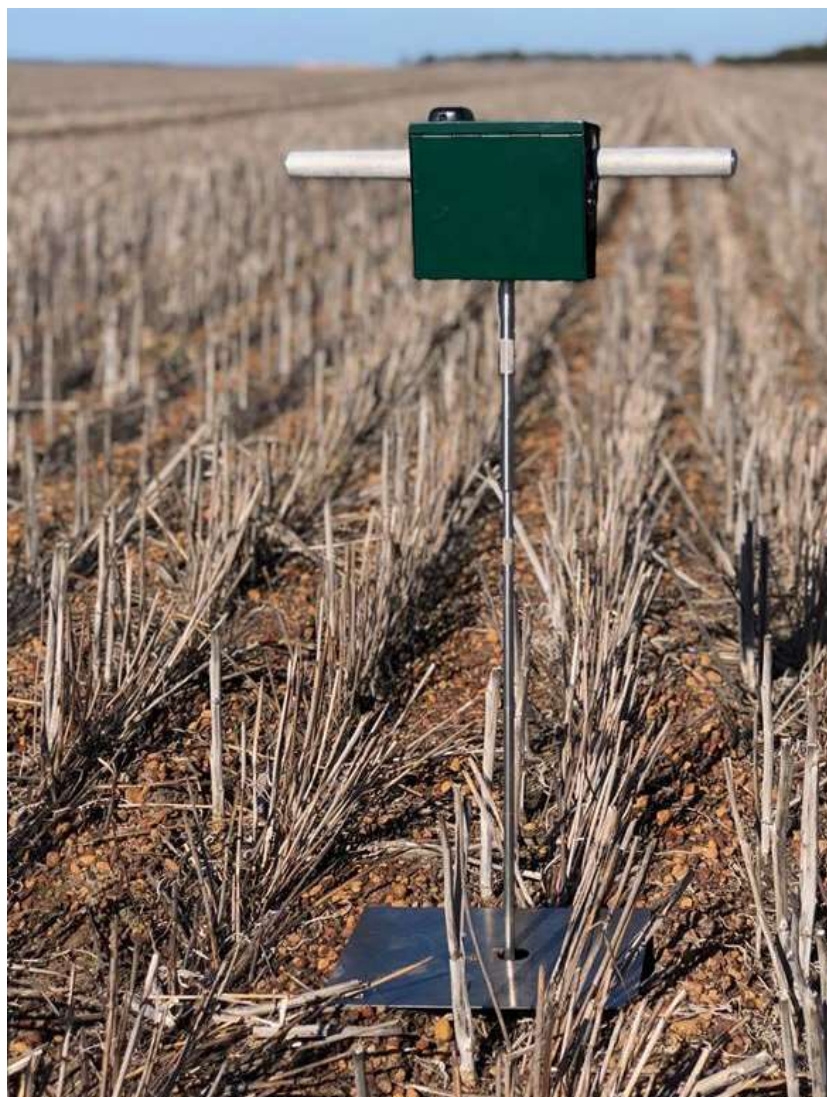
Рисунок 3.2. – Електронний твердомір Лан-М для визначення твердості ґрунту в польових умовах у відповідності до стандарту ASAE S313.3.
