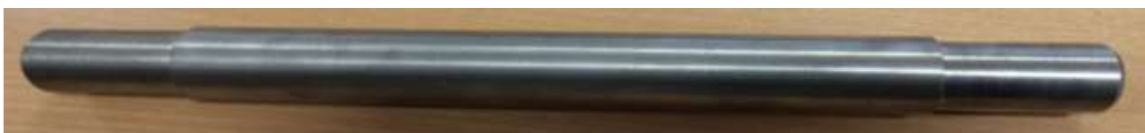
Рисунок 2.2 – Загальний вид ексцентрикового валу ( \Delta = 2,5 мм)
