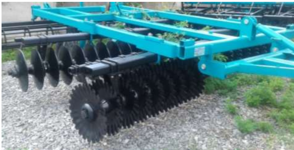
Рисунок 1.7 – Батареї плоских (А) і рифлених (Б) дисків
