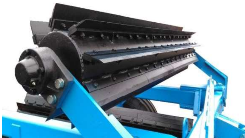
Рисунок 3.1 – Дослідний зразок катка в транспортному положенні
