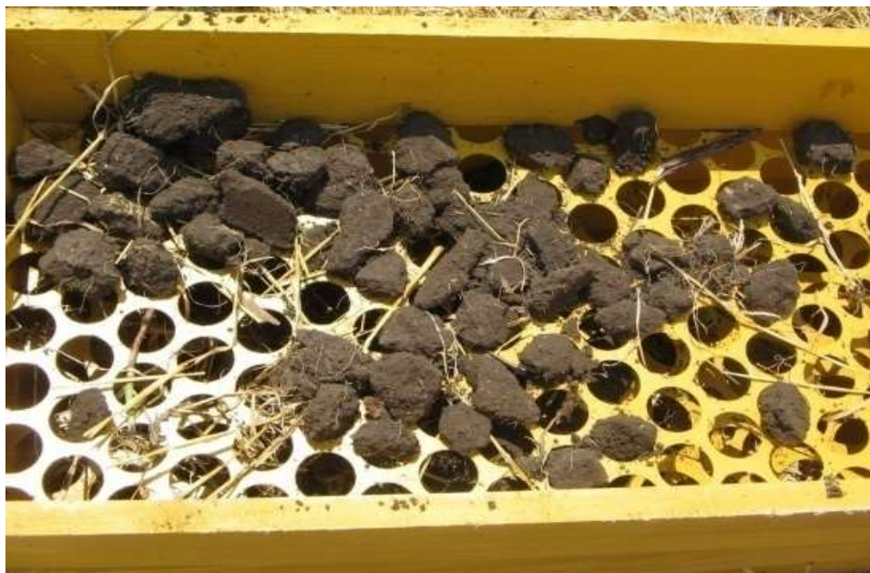
Рисунок 3.2 – Загальний вид решета для просіювання взятих проб
