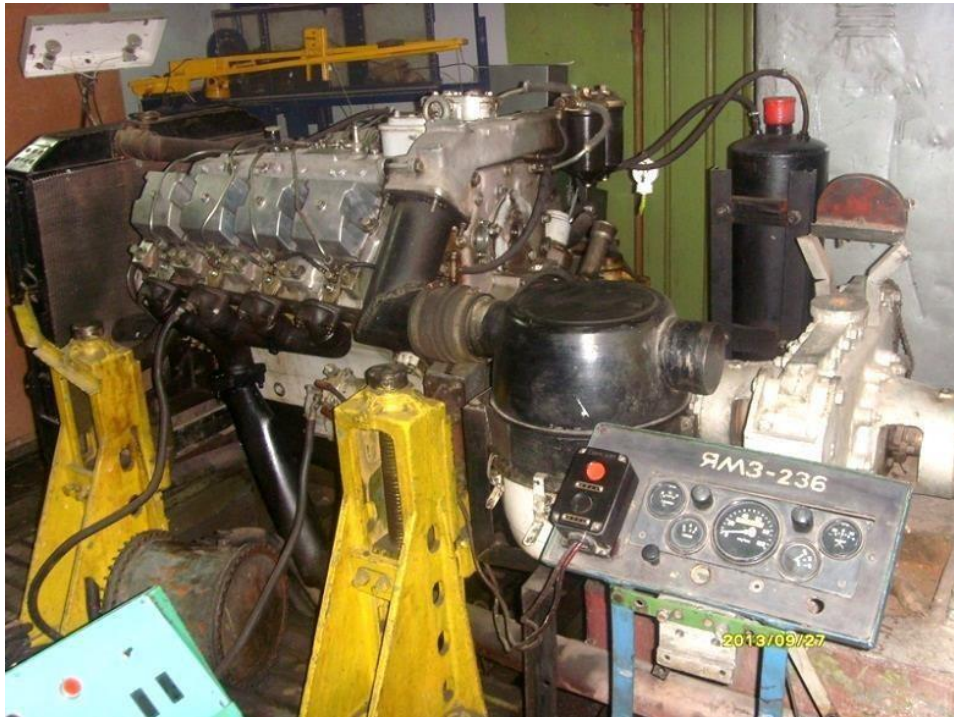
Рисунок 3.2 — Загальний вигляд випробувального стенда для дослідження ДВЗ.
