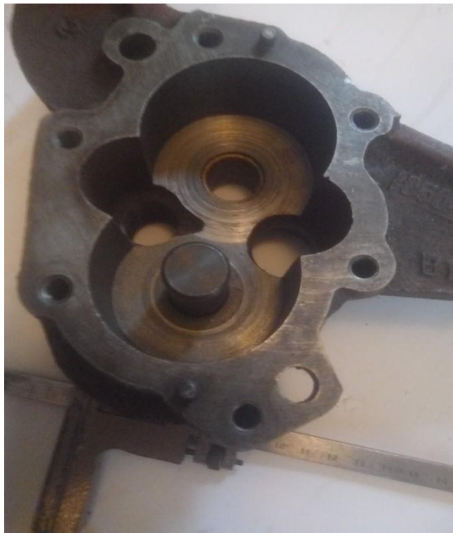
Рисунок 3.7 – Прояви гідроабразивного зношування поверхні «колодязя» корпусу масляного насоса
