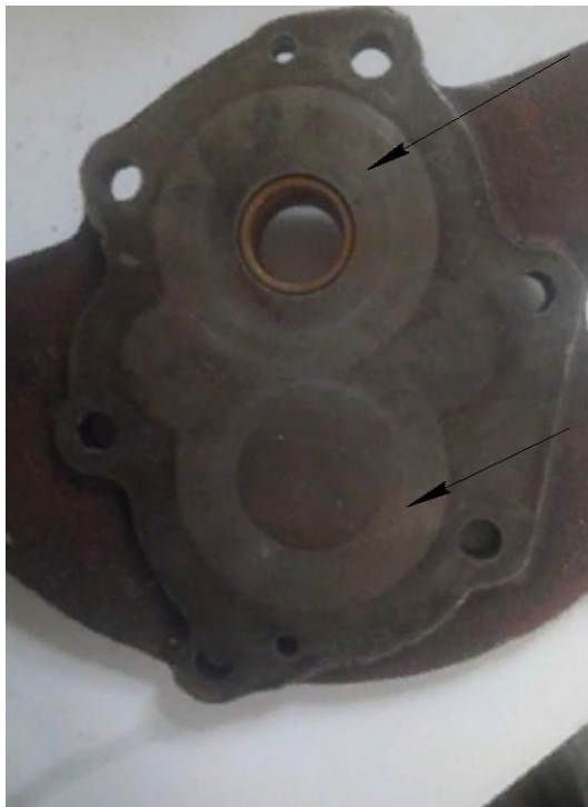
Рисунок 3.9 – Ознаки гідроабразивного спрацювання робочої поверхні кришки масляного насоса
