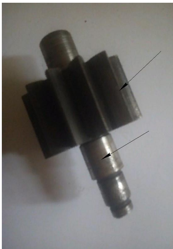
Рисунок 3.10 – Сліди гідроабразивного спрацювання на цапфах і зубі ведучої шестірні
