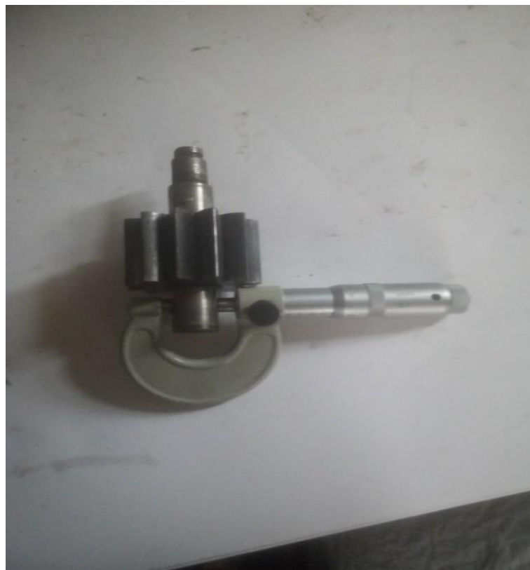
Рисунок 3.3 – Вимірювання діаметра цапф валів шестерень.
