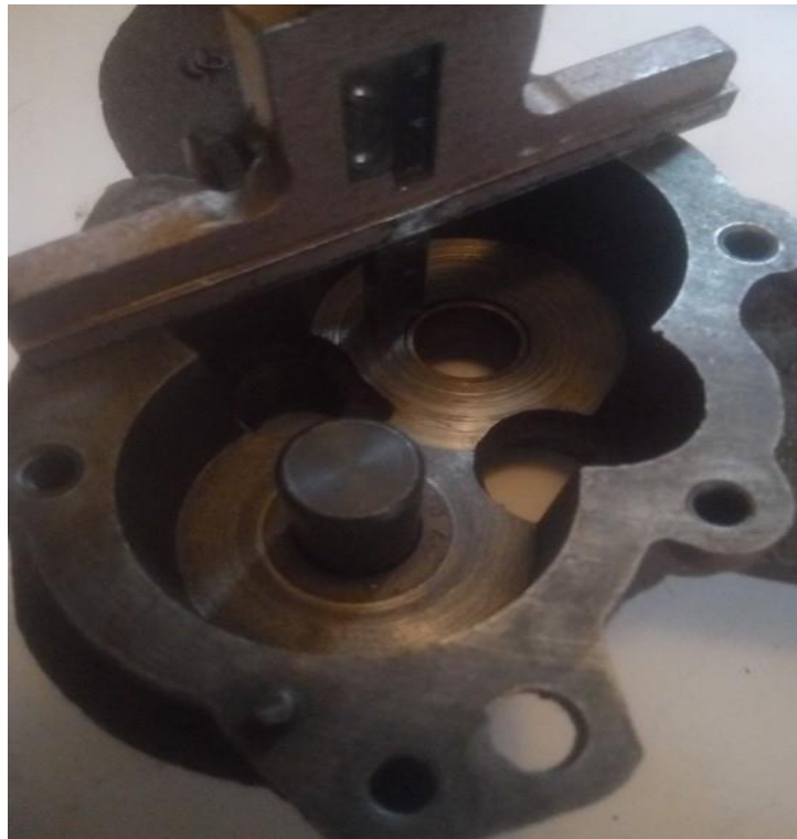
Рисунок 3.4 – Схема вимірювання глибини («висоти») колодязя корпусу насоса
