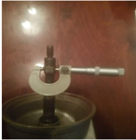
Рисунок 3.5 – Схема вимірювання діаметра посадкових поверхонь на осі ротора
