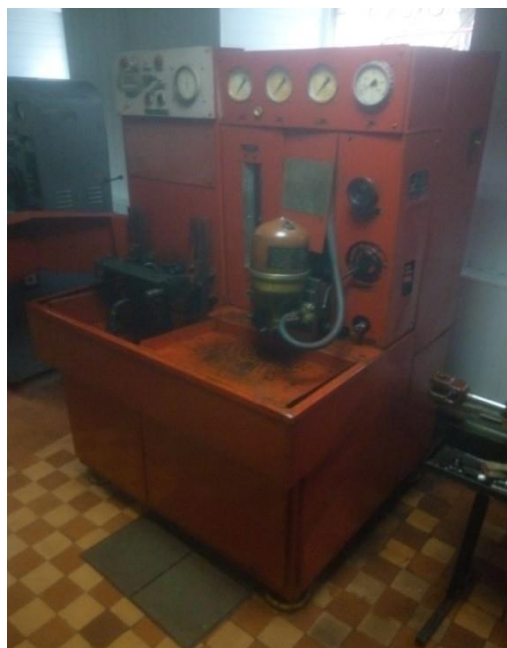
Рисунок 3.6 – Загальний вигляд стенда КИ-5278 для обкатки та випробування вузлів системи мащення ДВЗ
