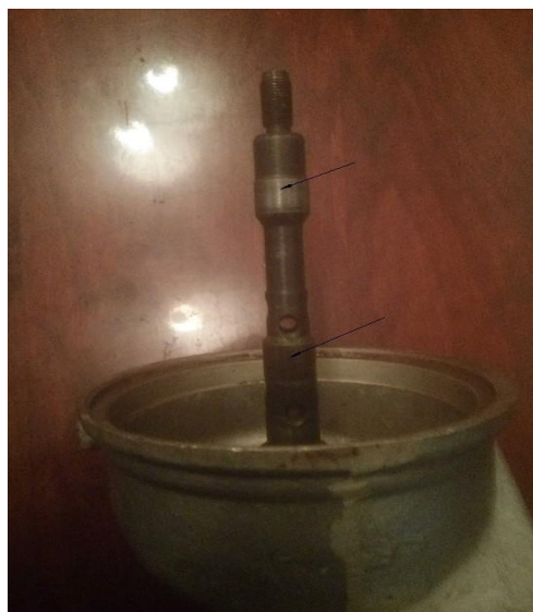
Рисунок 3.11 – Гідроабразивне спрацювання шийок осі ротора. Виявлене спрацювання зумовлене наявністю у робочій рідині абразивних частинок.
