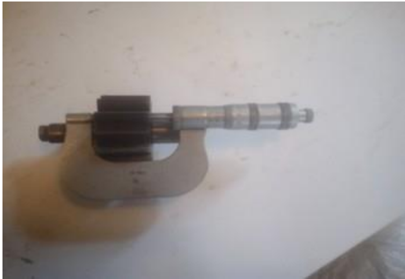
Рисунок 3.2 – Схема вимірювання висоти зубчастого колеса
