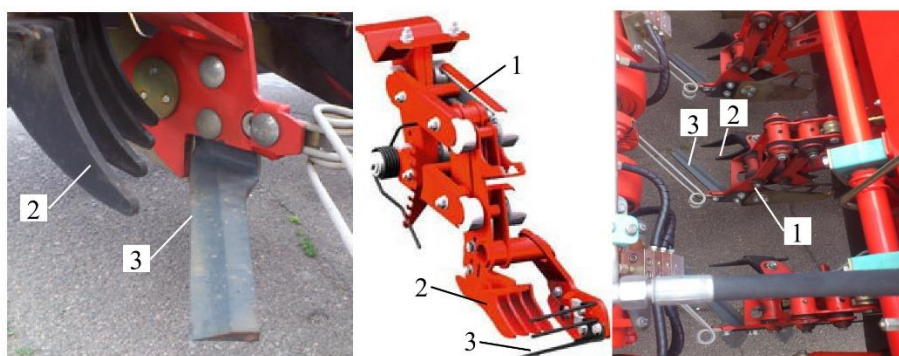
Рисунок 1.8 – Загальний вигляд обрізника залишків гички з головок коренеплодів:
