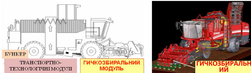
Рисунок 1.7 – Структурна схема модульної побудови коренезбиральної машини
