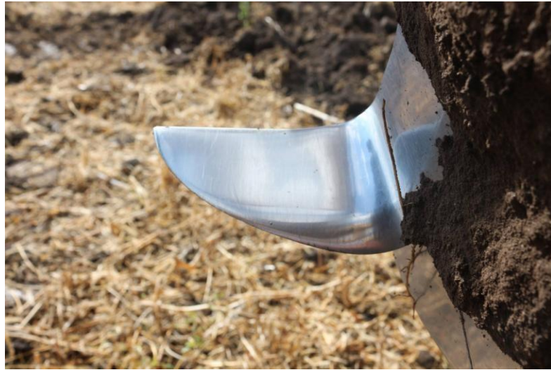
Рис. 1.4. Типова поверхня тертя робочих органів ґрунтообробних машин (робочі органи фірми «Веднар FMT», напрацювання агрегату 130 га, Попільнянський район Житомирська область)
