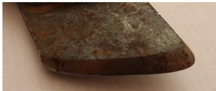
Рис. 2.5. Формоутворення різального елемента змінного долота леміша під час експлуатації на супіщаних ґрунтах
