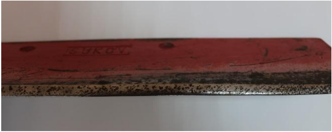
Рис. 2.6. Формоутворення різального елемента леза леміша під час експлуатації на легкій глині
