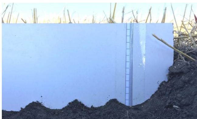
Рисунок 2.7 – Профіль дна борозни після проходу макетного зразка знаряддя
