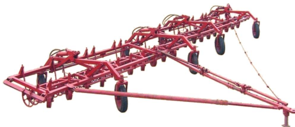
Рисунок 1.3 – Агрегат з активним приводом кільцевих робочих органів
