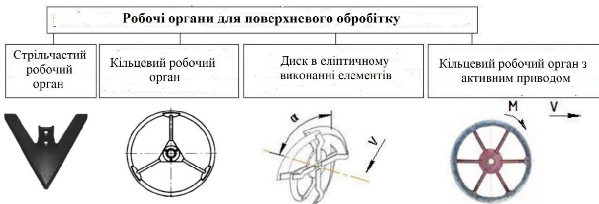
Рисунок 1.2 – Класифікація робочих органів для поверхневого обробітку ґрунту
