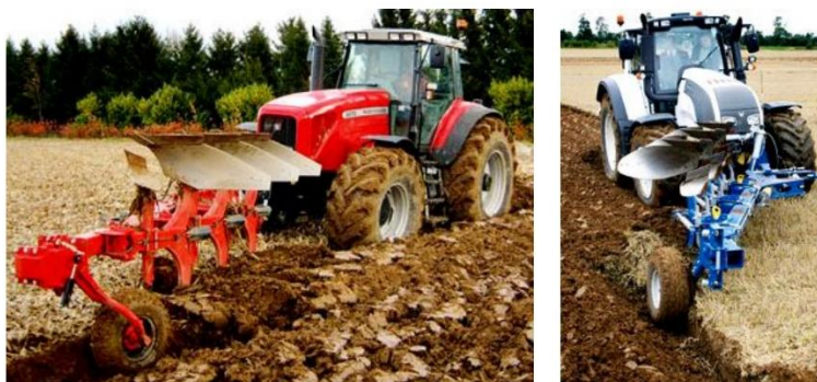
Рисунок 1.3 – Приклади розташування опорного колеса фронтального плуга у борозні
