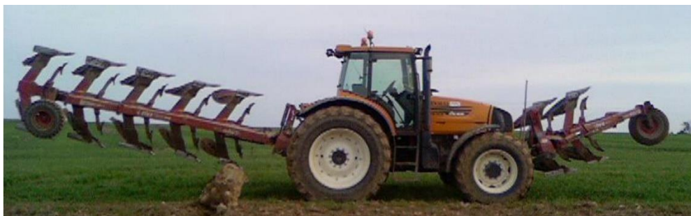
Рисунок 1.4 – Орний агрегат із двокорпусним фронтальним плугом
