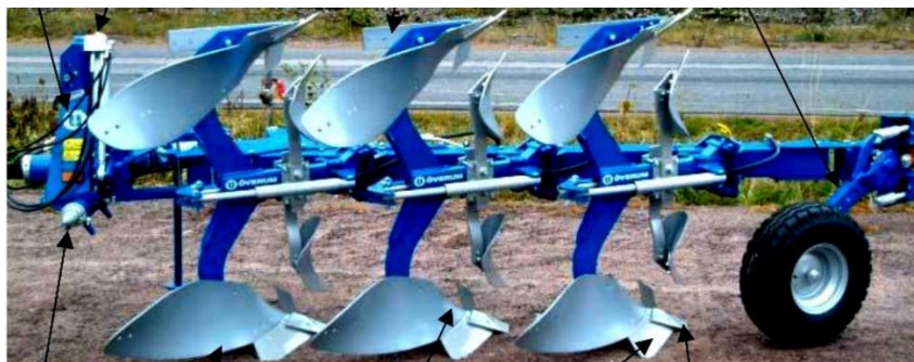
Рисунок 1.1 – Фронтальний плуг FX 31075H німецької фірми OVERUM
