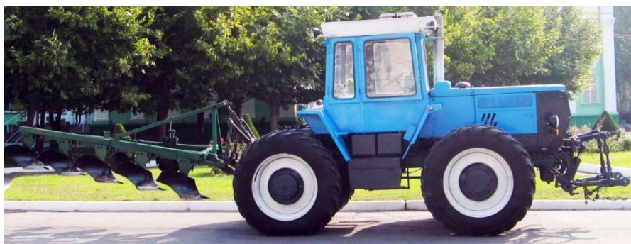
Рисунок 3.7 – Трактор ХТЗ-160 з плугом ПЛН-5-35 (схема «0+5»)
