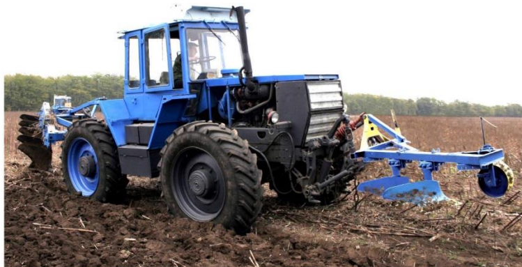
Рисунок 3.10 – Трактор ХТЗ-160 в агрегаті із чотирьохкорпусним задньонавісним та двохкорпусним фронтальним плугами (схема «2+4»)
