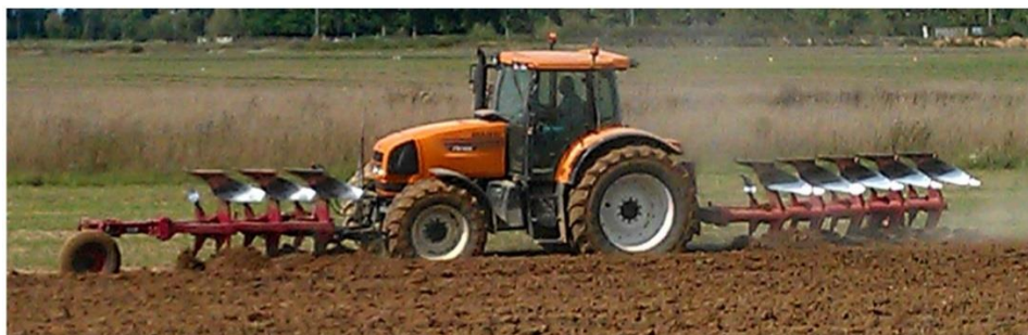
Рисунок 1.5 – Орний агрегат із трикорпусним фронтальним плугом
