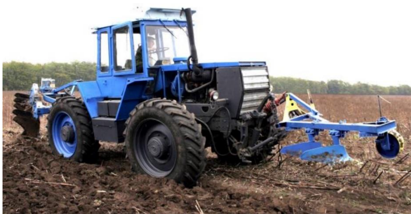
Рисунок 3.1 – Трактор ХТЗ-160 в агрегаті з фронтальним та задньонавісним тензометричним плугами
