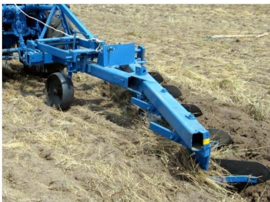
Рисунок 3.3 – Тензометричний плуг ПЛН-5-35
