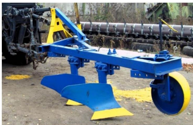
Рисунок 3.2 – Фронтальний плуг ПЛН -2-35
