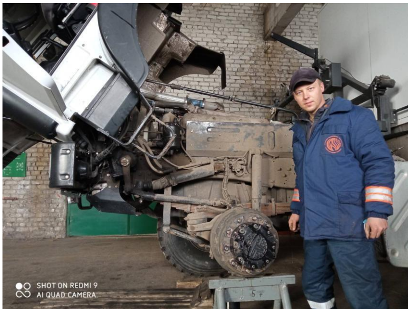
Рисунок 3.4 – Процес встановлення наконечників тяг у кермовому приводі автомобіля.
