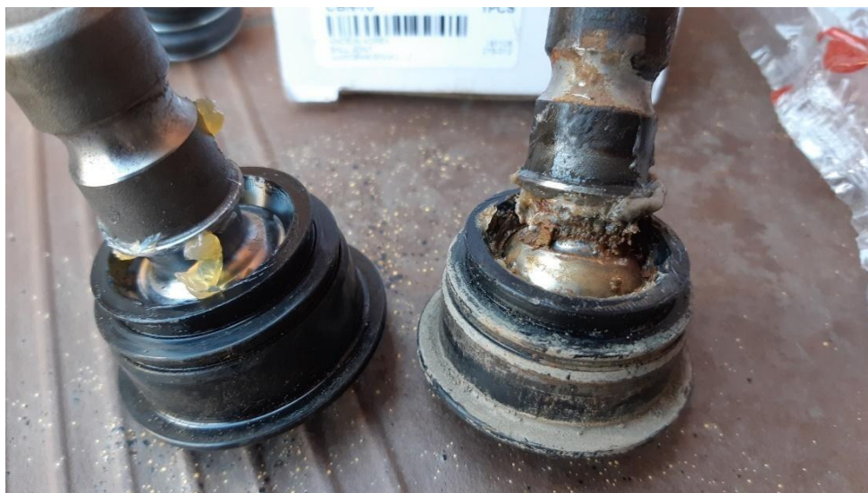
Рисунок 2.1 – Кульова опора: новий вузол і зразок у граничному стані.
