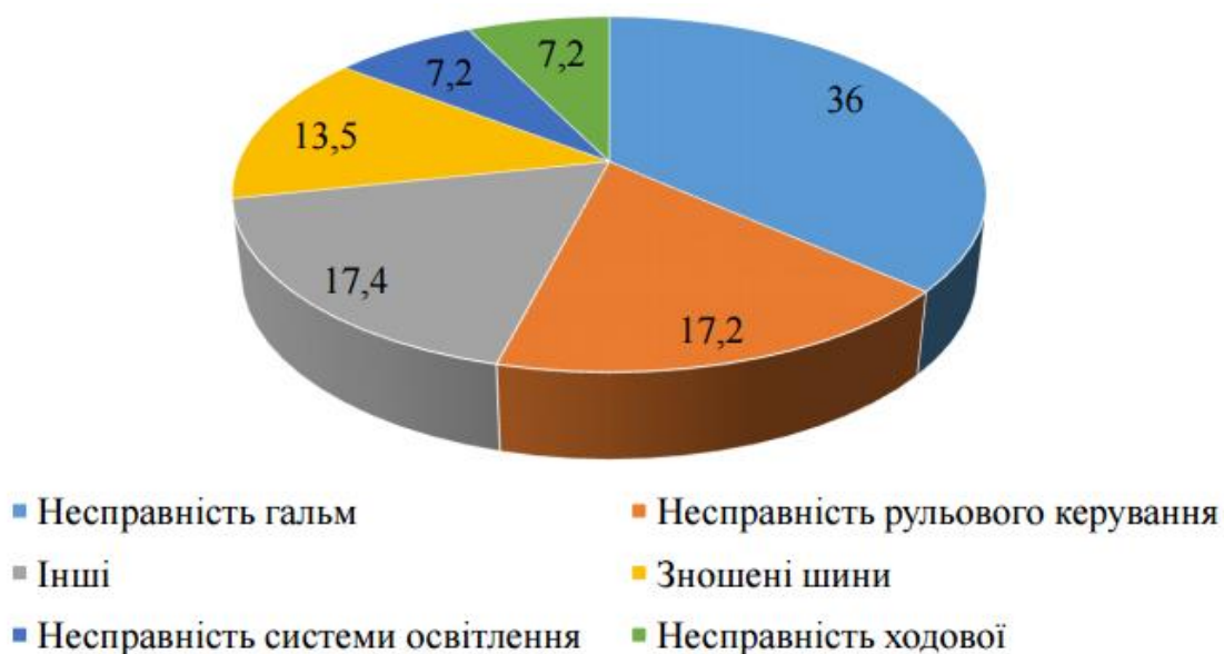
Рисунок 1.7 – Діаграма видів технічних несправностей автотransпортних засобів, що призводять до ДТП
