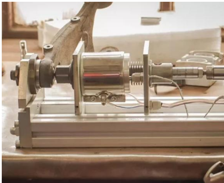
Рисунок 2.3 – Термопрес: регенерація полімерної втулки кульової опори.
