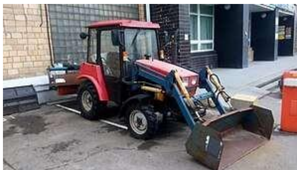
Рисунок 1.1 – Малогабаритний трактор BELARUS МТЗ-320.4, оснащений фронтальним навантажувачем і щітковим обладнанням
