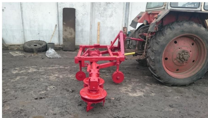
Рисунок 3.3 – Загальний вигляд експериментального зразка фрезерної машини МФ-1М з трактором ЮМЗ-6
