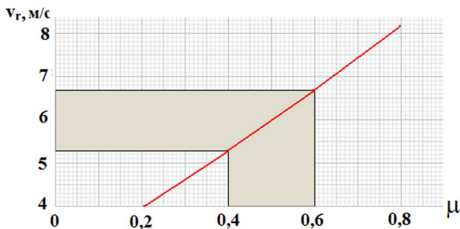
Рисунок 2.8 – Графік зміни швидкості V_r руху т. М по поверхні ножа від різних значень коефіцієнту тертя при лінійній швидкості ножа V_n=2,8 м/с і радіусі ножа
