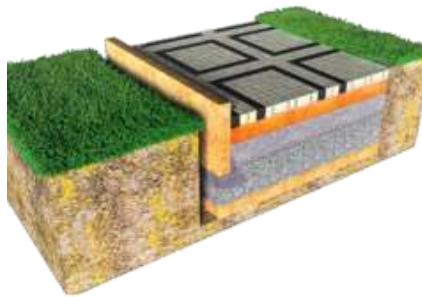
Рис.3.10. Влаштування бруківки на бетонну основу
