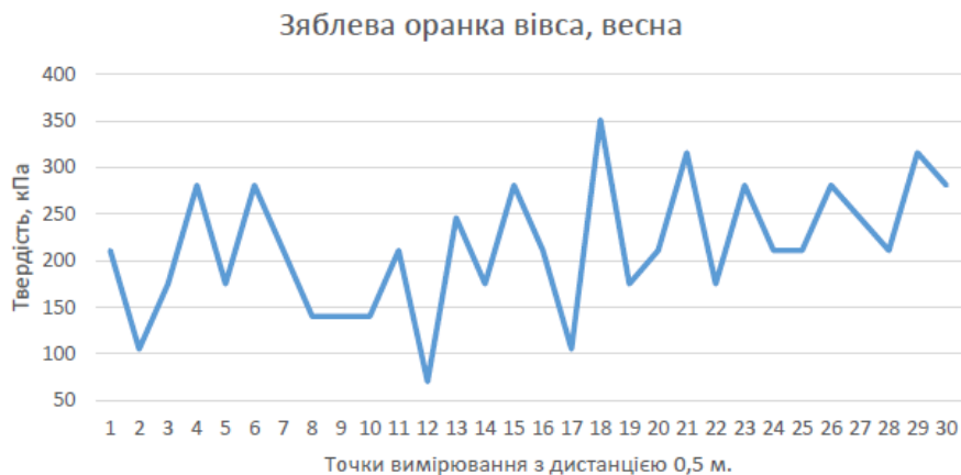
Рисунок 3.5 – Твердість ґрунту на глибині 0,05м, кПа
