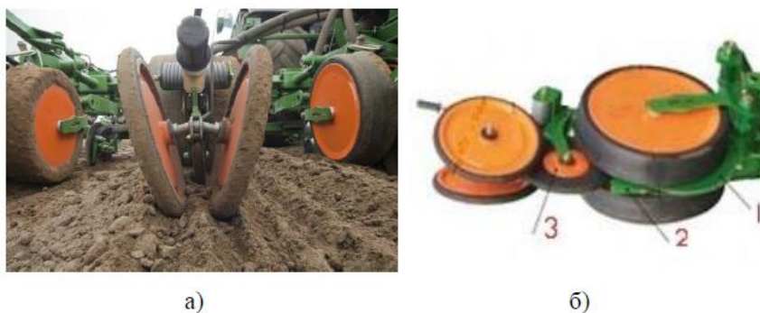
Рисунок 1.7 – Сошник просапних сівалок Amazona EDX 9000-TC та EDX 6000-TC: а – вид ззаду; б – вид знизу
