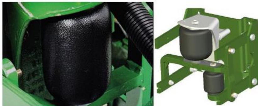
Рисунок 1.16 – Пневмоциліндри на паралелограмі секції сівалки John Deere
