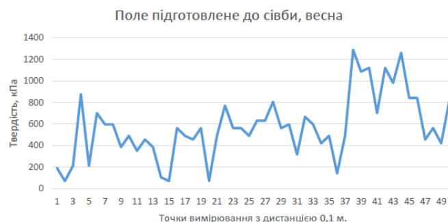
Рисунок 3.8 – Твердість ґрунту на глибині 0,05м, кПа
