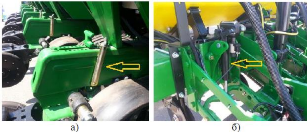
Рисунок 1.17 – Система Delta Force: а – тензо-датчик; б – гідроциліндр
