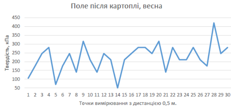
Рисунок 3.6 – Твердість ґрунту на глибині 0,05м, кПа
