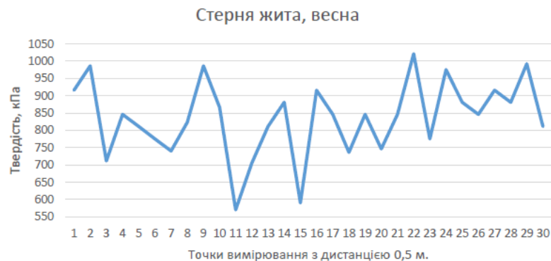
Рисунок 3.7 – Твердість ґрунту на глибині 0,05м, кПа
