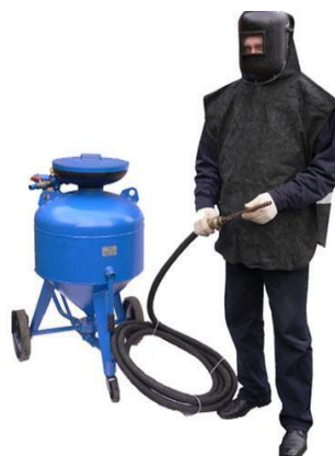
Рисунок 1.8 – Абразивно-струминна установка нагнітального типу з сопловою насадкою
