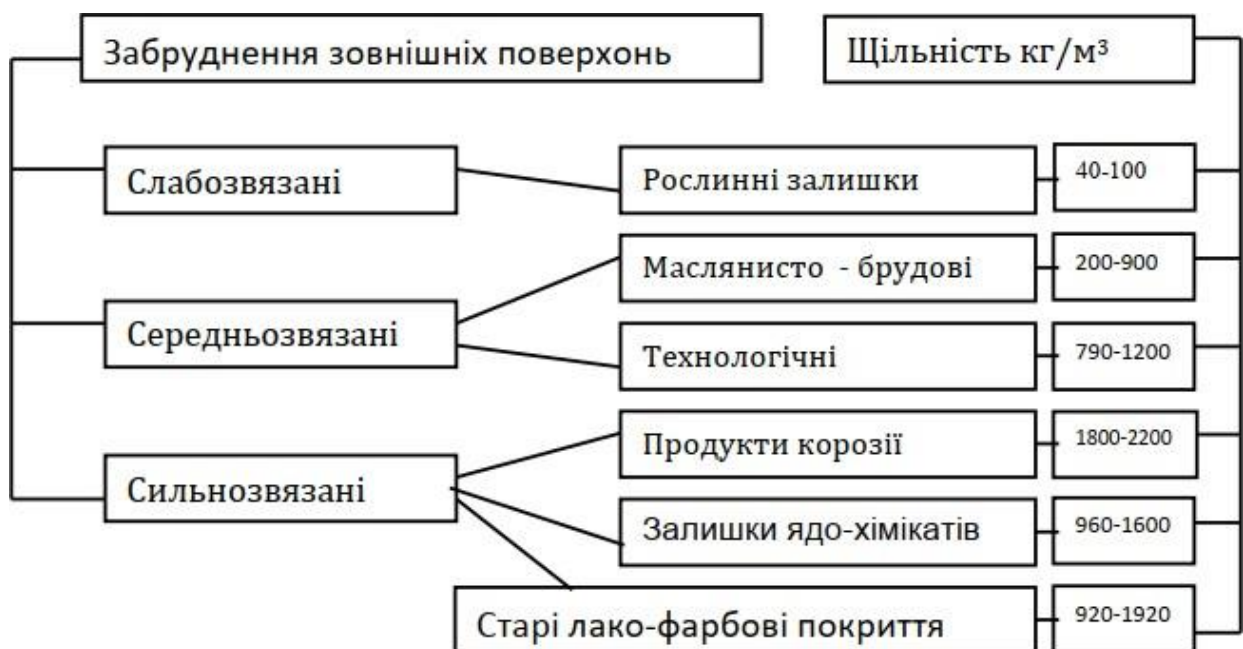
Рисунок 1.2 – Класифікація поверхневих відкладів за рівнем адгезії та складністю очищення
