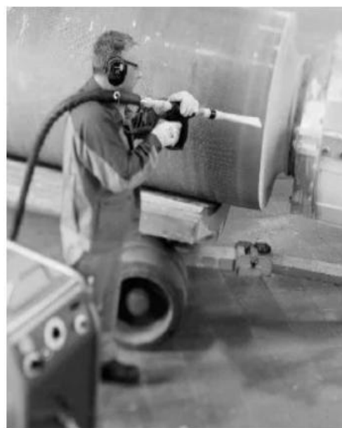
Рисунок 3.3 – Експериментальна установка для знежирення та очищення зовнішніх поверхонь техніки при підготовці до фарбування
