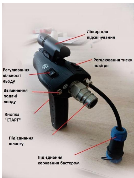
Рисунок 3.3 – Експериментальна установка для знежирення та очищення зовнішніх поверхонь техніки при підготовці до фарбування
