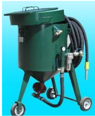
Рисунок 1.7 – Абразивно-струминна установка з усмоктувальним принципом дії
