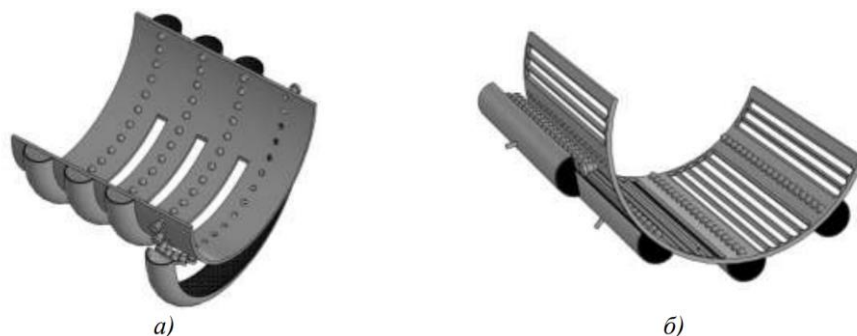
Рисунок 2.7 – Конструктивні особливості частини дека, який за допомогою взаємодії з ротором здійснює основний етап обмолоту та дообмолот
