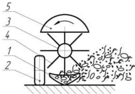
Рисунок 1.1 - Технологічна схема картоплекопача КТН-1А 1 - леміш; 2 - опорне колесо; 3 - роторне колесо; 4 - гребінка; 5 - захисний кожух.
