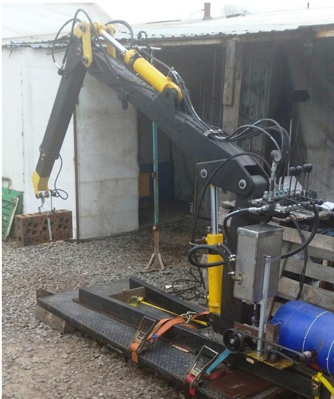
Рис. 3.1. Розроблена експериментальна установка крана-маніпулятора з гідравлічним приводом
