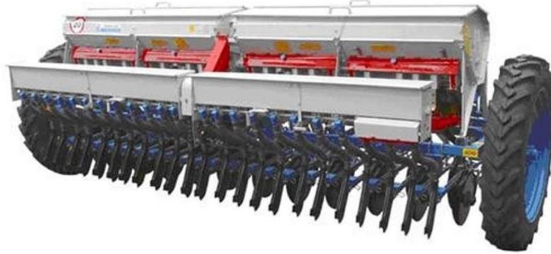
Рисунок 1.1 – Загальний вигляд сівалки СЗТ-3,6А з пристроєм для сівби дрібнонасінневих культур
