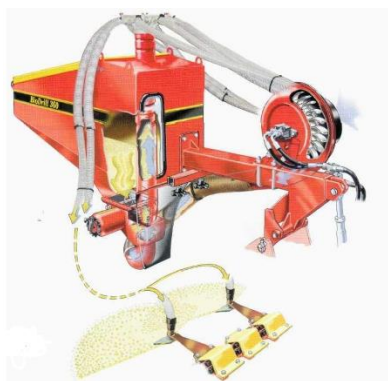
Рисунок 1.3 – Загальний вигляд ґрунтообробної комбінації BioDrill+Carrier фірми «Vaderstad» з пневматичною версією транспортування насіння до сошників
