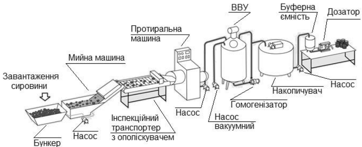
Рис. 4.5. Виробнича лінія отримання томатної пасту.
