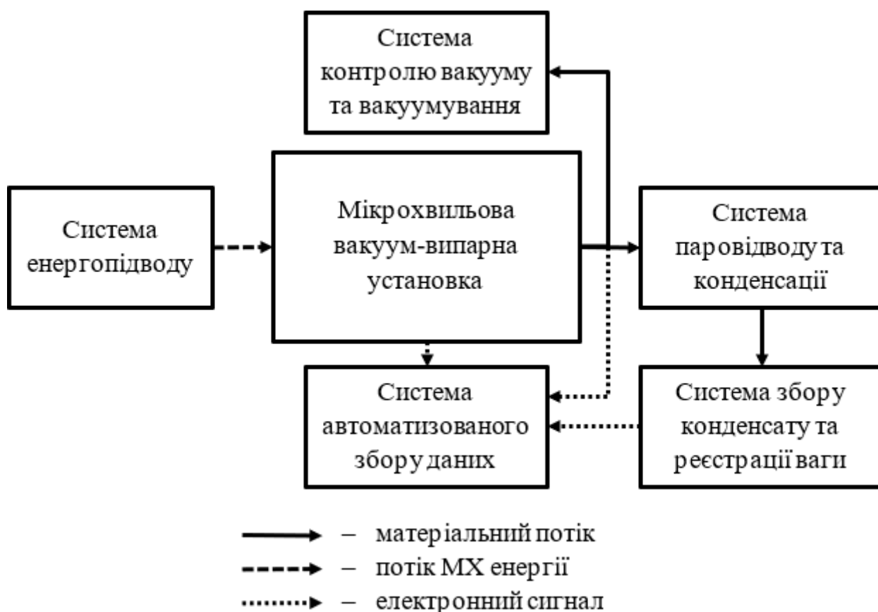
Рис. 2.2. – Схема стенду для дослідження процесу випарювання в умовах дії МХ поля.
