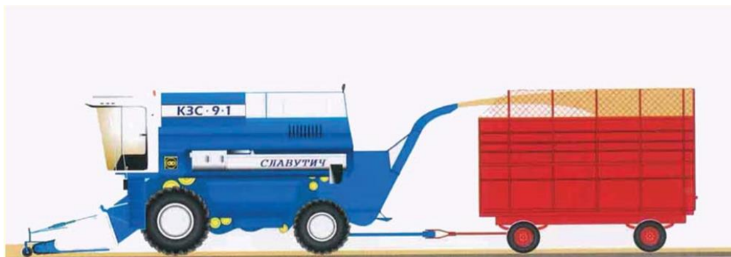
Рис. 1.6 – Схема потокового відбору та транспортування соломи й половини під час роботи зернозбирального комбайна.
