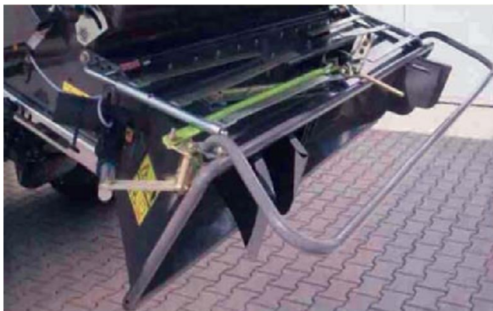
Рис. 1.10 – Подрібнення соломи та її подальше розсіювання по полю здійснюється вбудованою системою комбайна.
