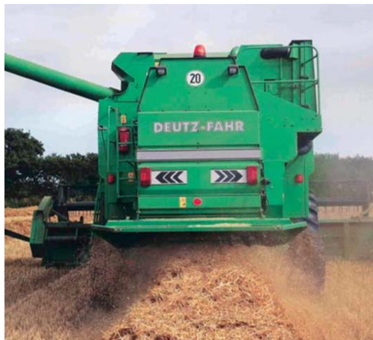
Рис. 1.7 – Формування валка з неподоланої (неподрібненої) соломи під час роботи комбайна.
