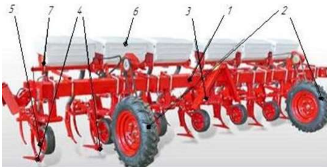
Рисунок 1.13 Культиватор КРНВ 4,2 : 1 рама; 2 опорноприводные колеса; 3 навісний пристрій; 4 лапа; 5 стійка; 6 бункер (6 шт.); 7 туківсевающий апарат АТ 2 (6 шт.)
