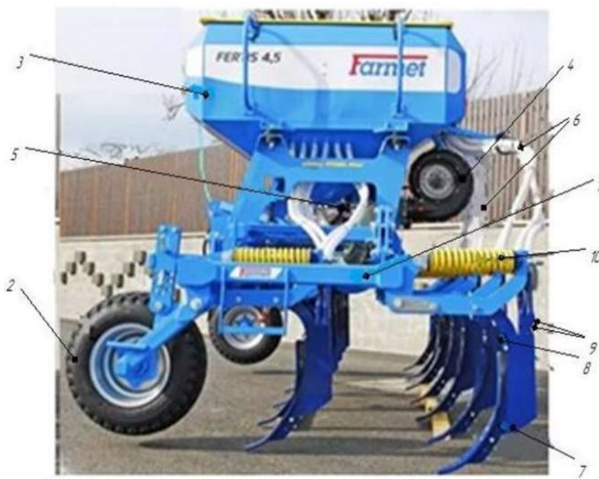
Рисунок 1.14 Культиватор з внесенням добрив Fertis 4,5 : 1 рама; 2 опорні колеса; 3 бункер для мінеральних добрив; 4 вентилятор; 5 дозуючий пристрій; 6 тукороводи; 7 чизельна лапа; 8 стійка; 9 удобрювачі; 10 пружинний захист.
