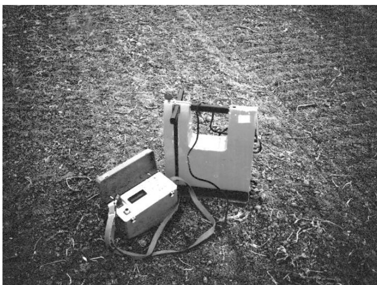
Рисунок 3.3 - Радіоізотопний щільномір РПП-2
