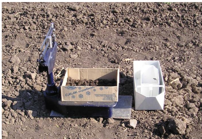
Рисунок 3.2 - Визначення якості розпушення ґрунту
