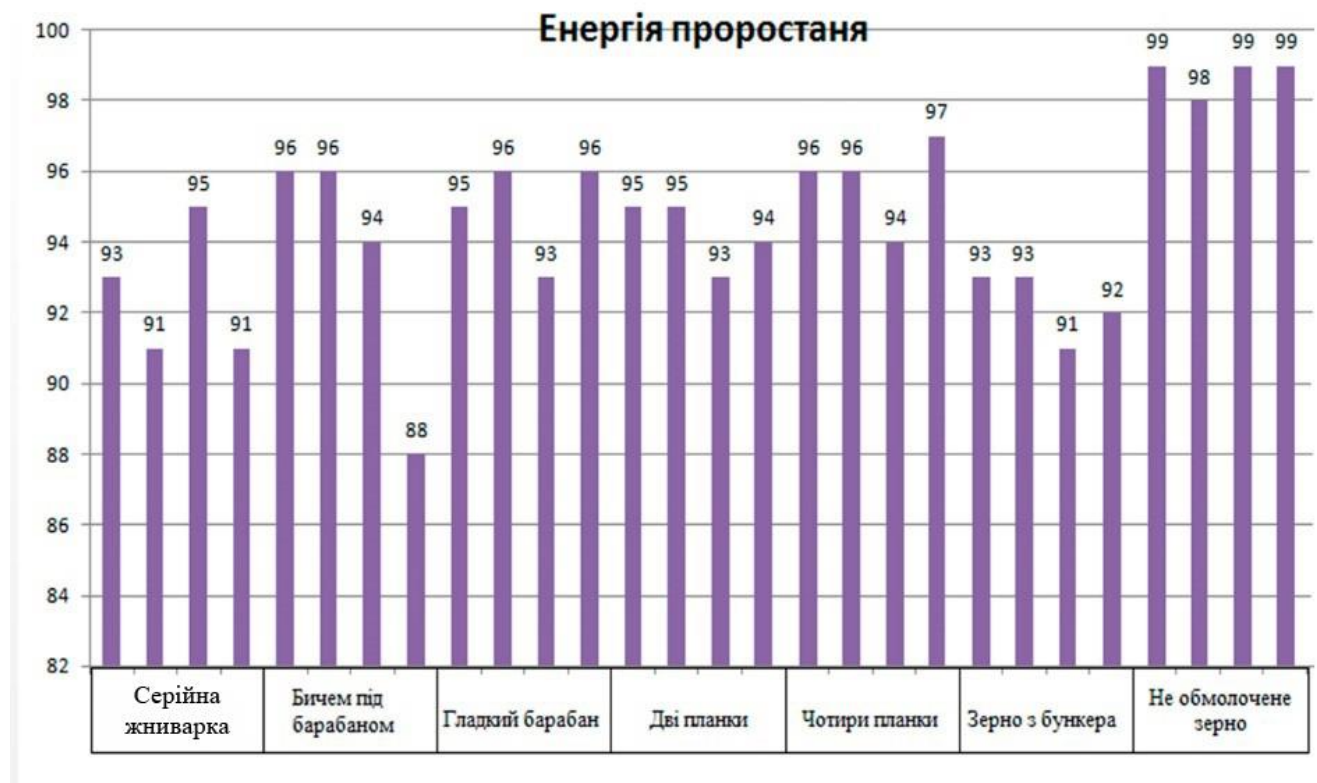
Рис. 2.11. Енергія проростання насіння пшениці, відділеного пристроєм попереднього обмолоту при зміні типу барабанів
