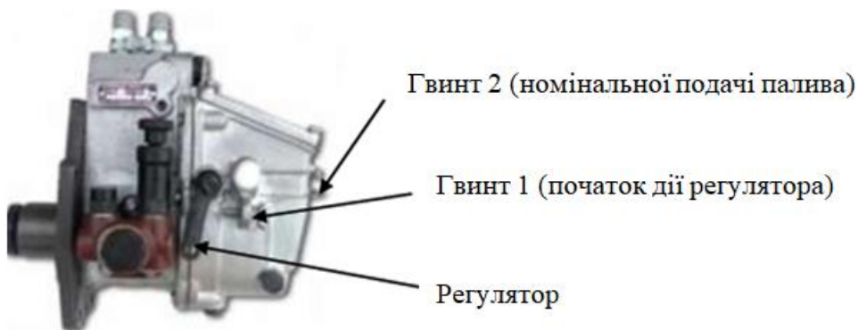
Рисунок 3.1 Паливний насос високого тиску 2УТНІ
