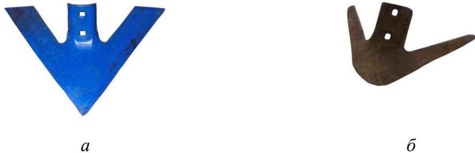
Рисунок 1.5 – Загальний вигляд нової ( a ) та зношеної ( б ) культиваторної лапи КПЕ-410 в умовах піщаних ґрунтів
