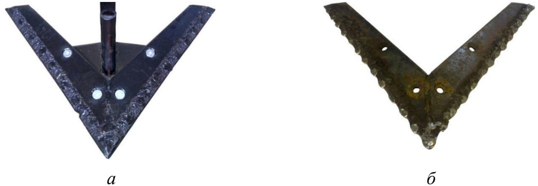
Рисунок 1.9 – Загальний вигляд нової (а) та зношеної (б) лап культиватора КВАНТ–12 в умовах чорноземних ґрунтів
