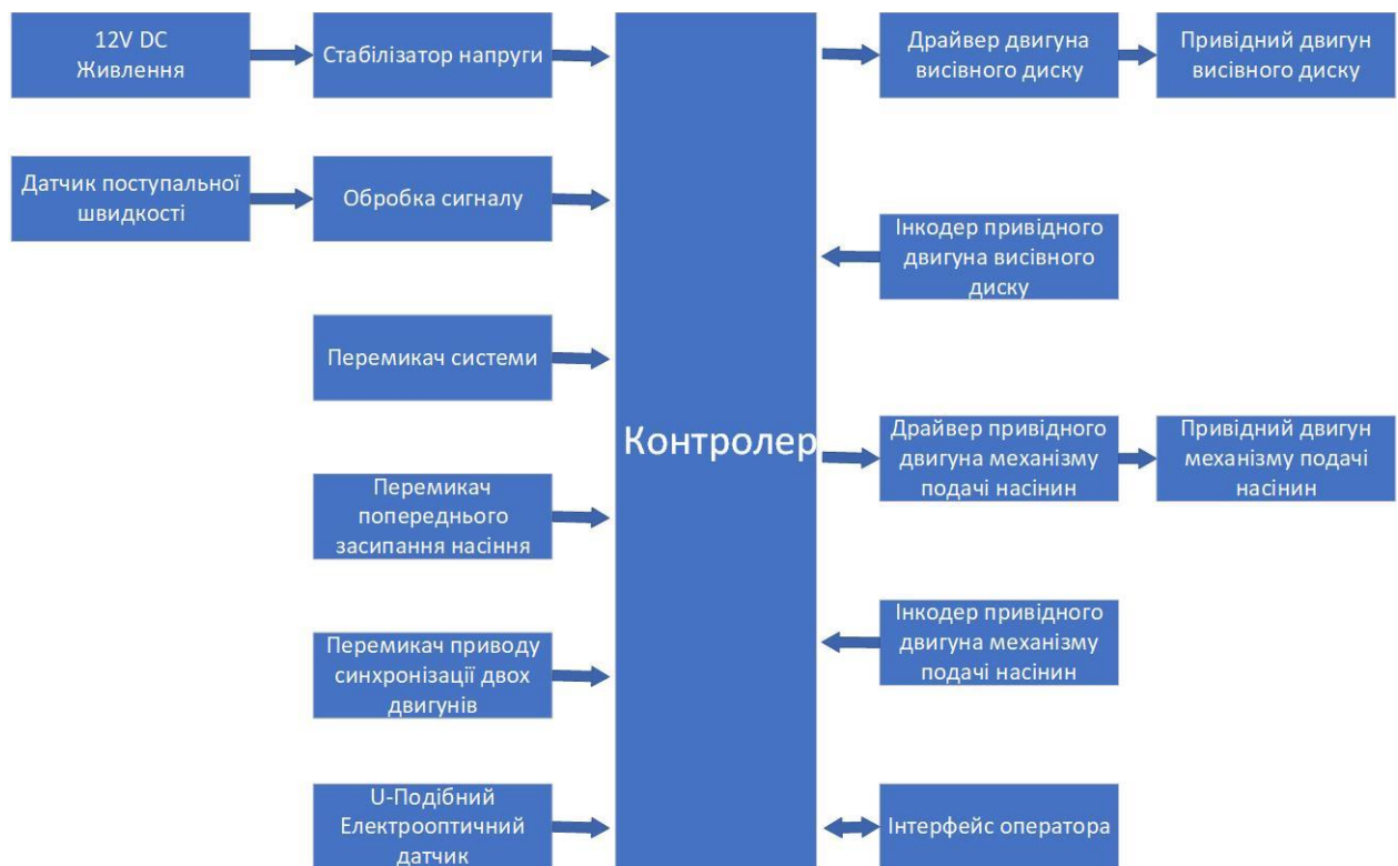
Рисунок 3.1. Блок-схема механізму точної доставки насіння
