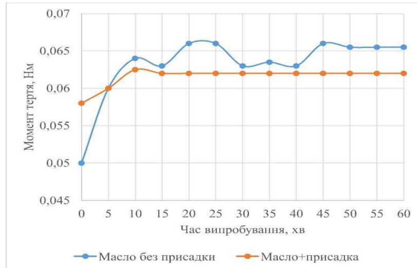
Рис. 3.5. Залежність моменту тертя від часу роботи з'єднання
