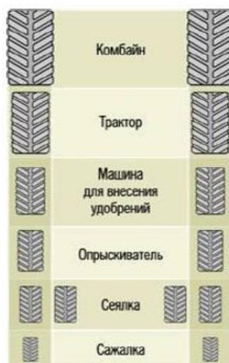
Рисунок 1.6 – Однакова ширина колії для всіх машин
