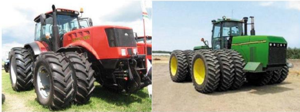
Рисунок 1.3 – Використання здвоєних, строєних шин
