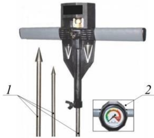
Рисунок 2.4 – Пенетрометр (твердомір): 1– робочі стержні, 2 – дисплей в межах від до 450 мм, діапазон вимірювань тиску від 0 до 100 кг/см 2
