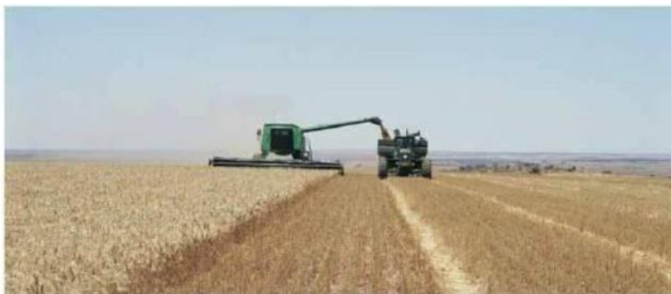
Рисунок 1.5 – Вивантаження зерна комбайном у вантажівку, що рухається сусідньою технологічною колією
