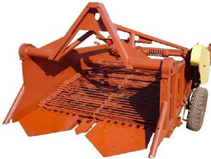
Рис 1.8 – Картоплекопач КТН – 2В
