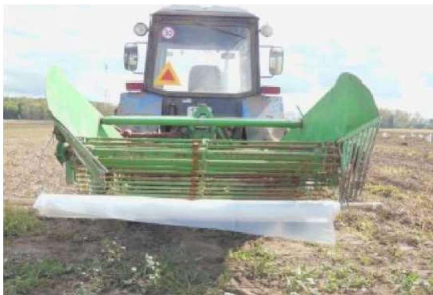
Рисунок 3.8 - Удосконалений картоплекопач КТН-2В під час визначення повноти збирання (вид ззаду)
