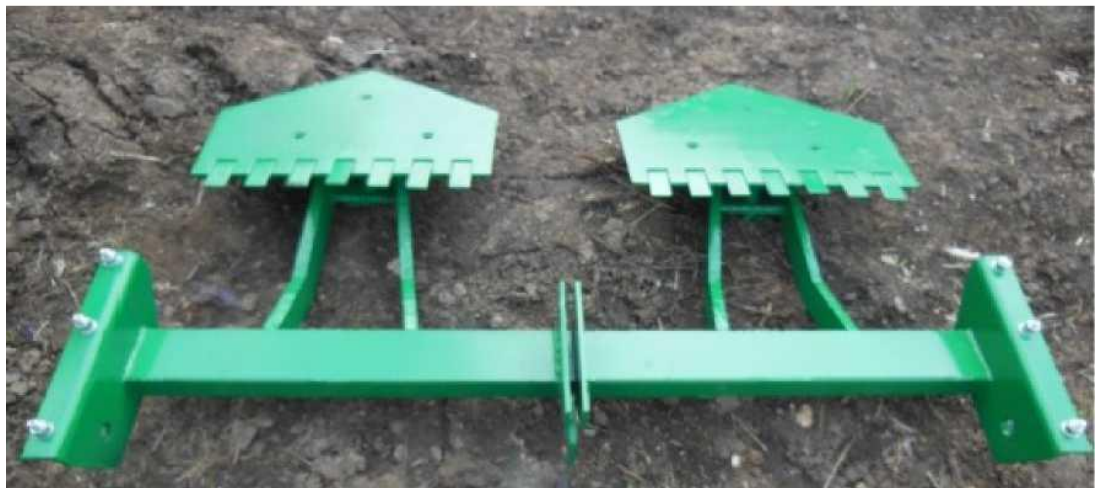
Рисунок 3.1 – Загальний вигляд удосконаленого підкопувального пристрою
