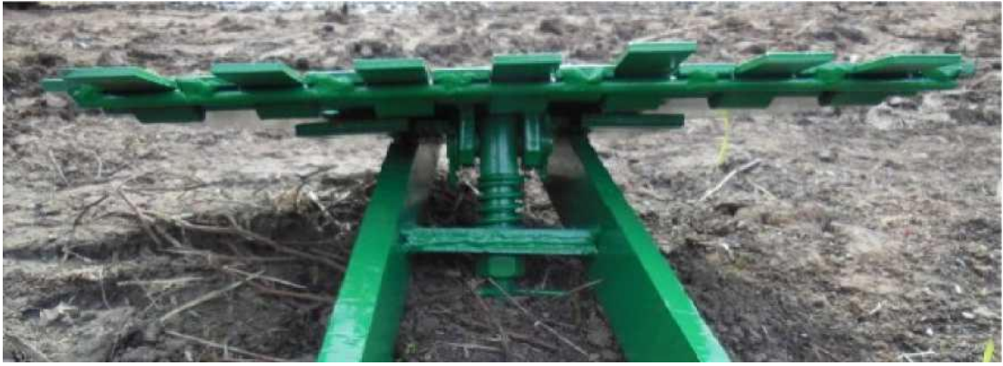
Рисунок 3.2 – Загальний вигляд пружинного механізму вдосконаленого робочого органу, що підкопує
