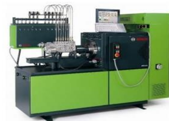
3.6. фото – діагностична станція ТНВТ ЕПС 815
