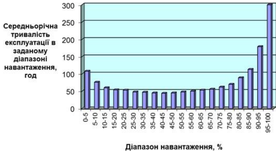
5.2. Рисунок - Середньорічна напрацювання двигуна в різних режимах роботи
