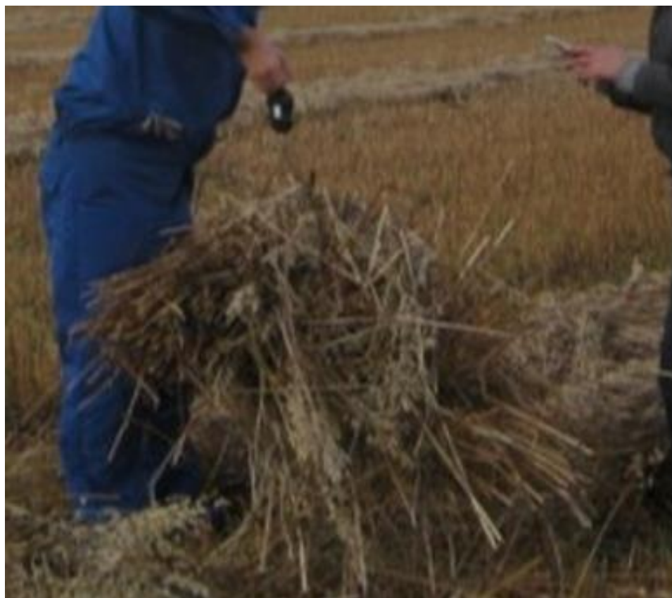
Рис. 3.1 Визначення маси погонного метра валка хлібної маси
