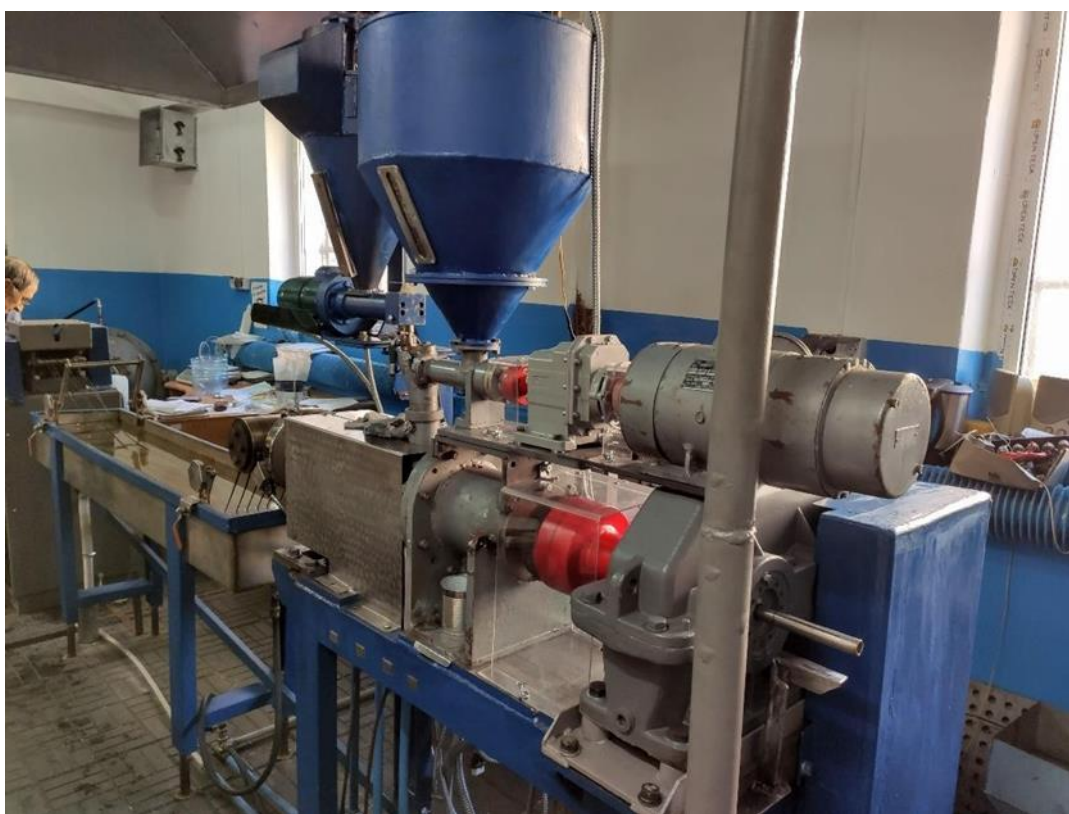
Рис. 3.2. Дослідний екструдер ЕКГ-45, що використовувався в експерименті
