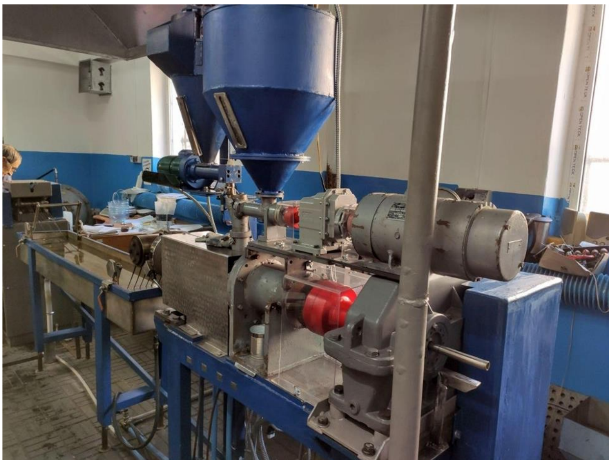
Рис. 4.1. Типовий вигляд екструдера ЕКГ-45, розміщеного в лабораторії № 018 на ізолюючій основі з виконаним належним заземленням
