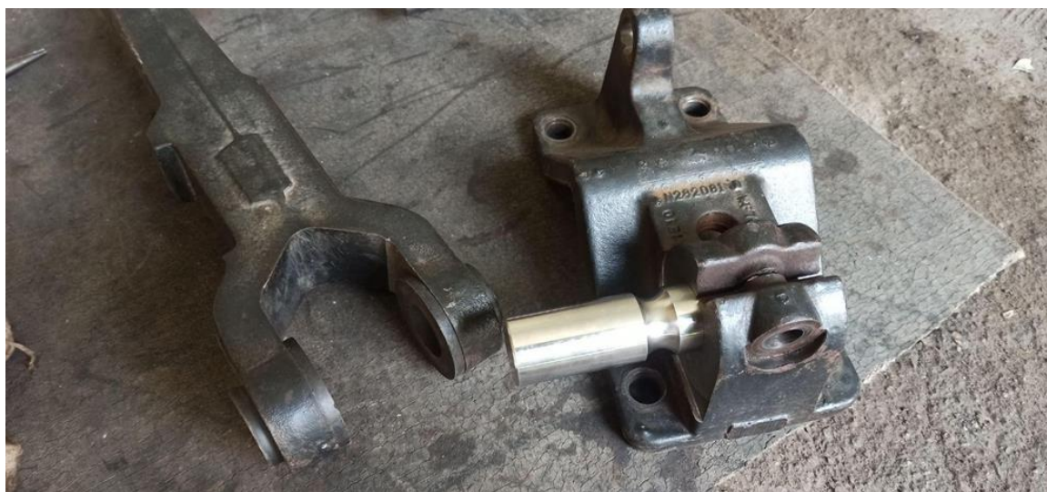
Рис. 3.9. Структура трибологічного з'єднання кінематичної пари - важеля прикотного колеса, що є частиною посівного комплексу John Deere 1895
