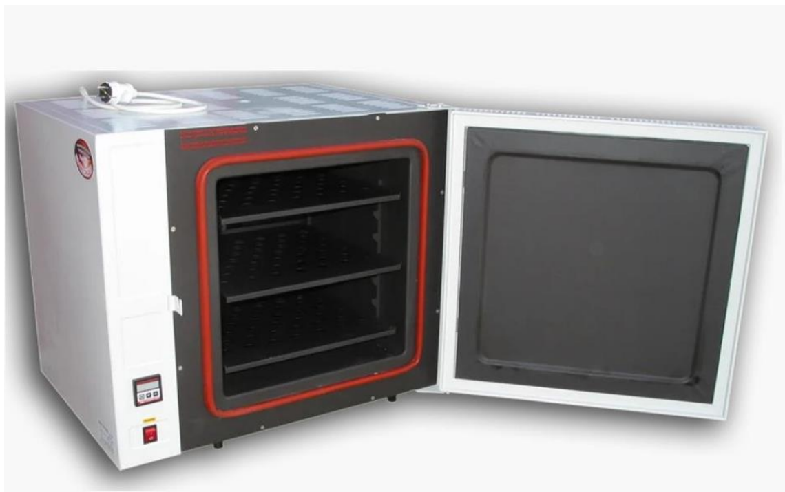
Рисунок 3.2. Конструкція та компоненти термостата СНОЛ 67/350, який являє собою шафу для термообробки
