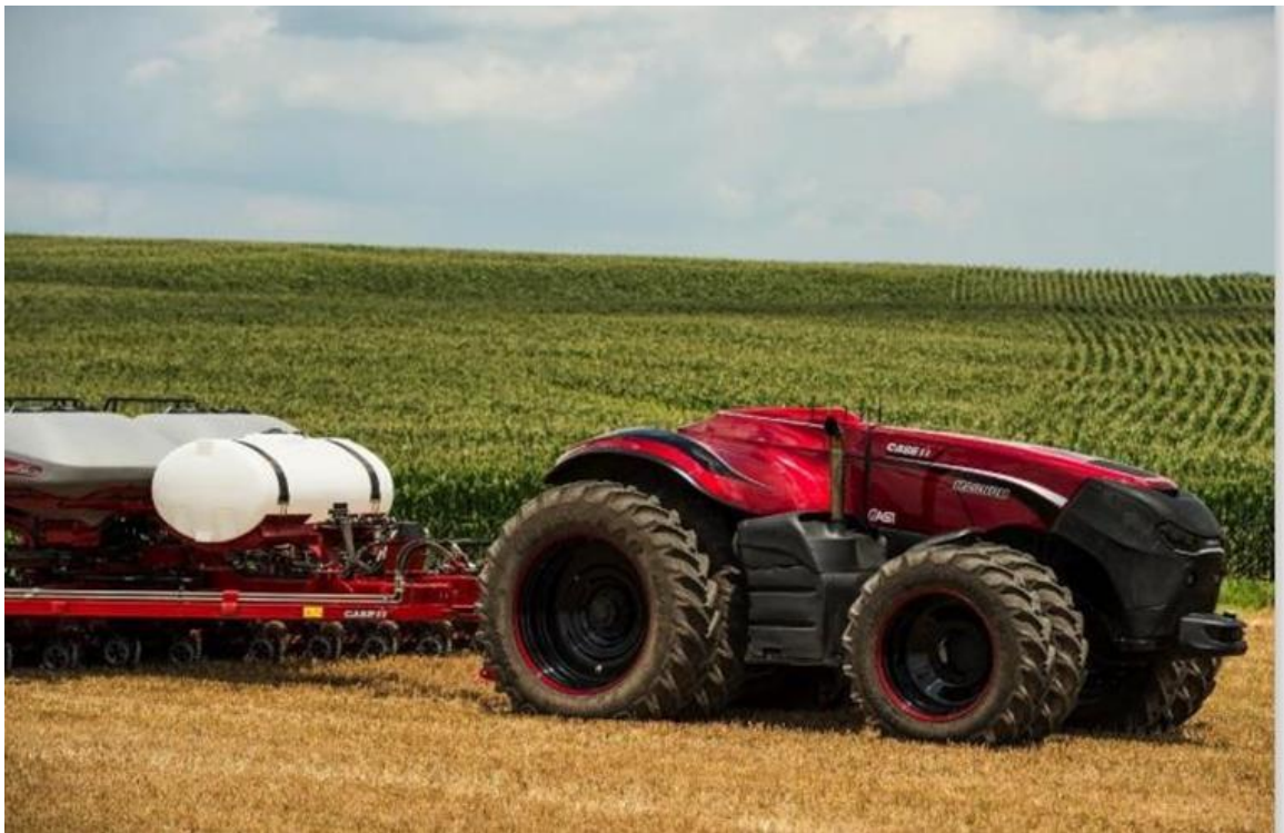
Рис. 1.2. Автоматизований трактор типової тягово-енергетичної структури
