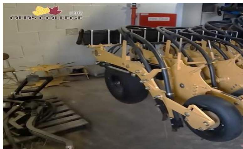
Рис. 1.4. Посівні секції, призначені для агрегатування з Autonomous Farm Robot, сконструйовані із застосуванням загальноприйнятих інженерних рішень
