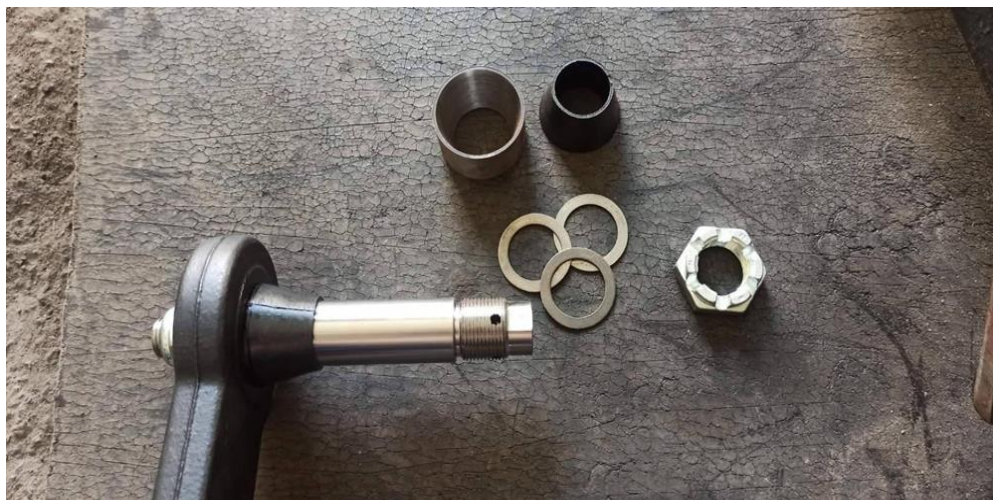
Рис.3.11. Трибологічна пара в оновленому важелі опорного колеса посівного комплексу John Deere 1895
