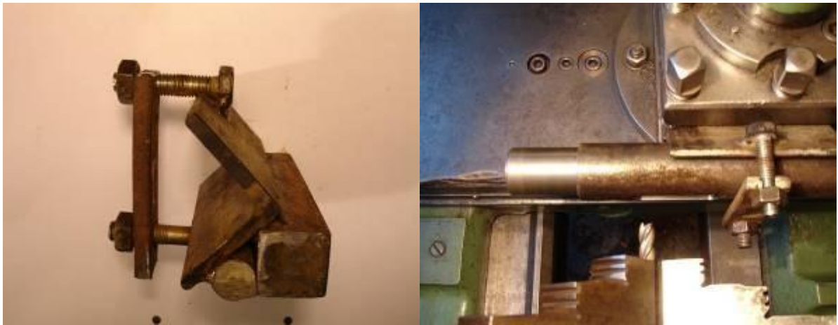
Рис. 2.2. Технологічне оснащення для фрезерної обробки пазів під з'єднувальні елементи
