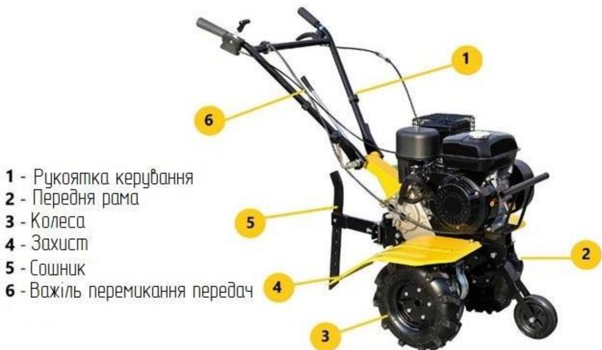
Рис. 1.1. Загальна конструктивна будова мотоблока
