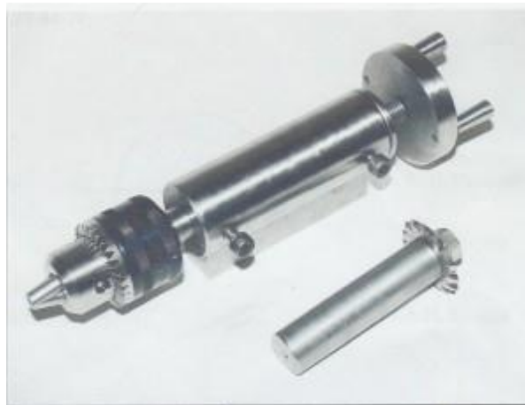
Рис. 2.1. Спеціалізований пристрій для виконання фрезерування пазів під шпонку з використанням токарного обладнання
