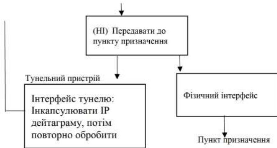
Рисунок 3.2-Схема алгоритму IPsec, застосований до процесу вихідних пакетів
