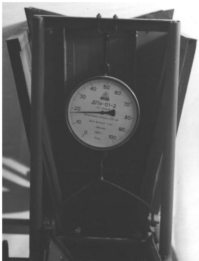
Рисунок 3.12 – Загальний вигляд установки для визначення кута вкладання частинок матеріалу
