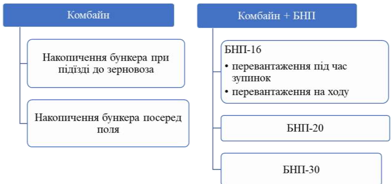
Рисунок 2.1 Схема роботи комбайнів та БНП
