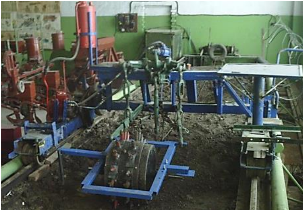
Рисунок 3.3 – Експериментальна модель котка ударної дії на ґрунтовому каналі.
