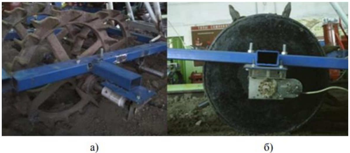
Рисунок 3.10 – Дослідження ковзання: а) модель кільчасто-шпорової котка з встановленим датчиком обертів; б) каток ударної дії із встановленим датчиком обертів
