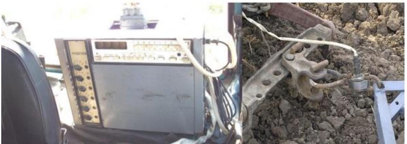
Рисунок 3.9 – Розміщення апаратури та тензометричного вузла при польових дослідженнях
