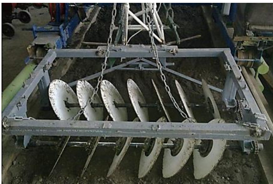
Рисунок 3.2 – Експериментальна секція дискової борони на ґрунтовому каналі.
