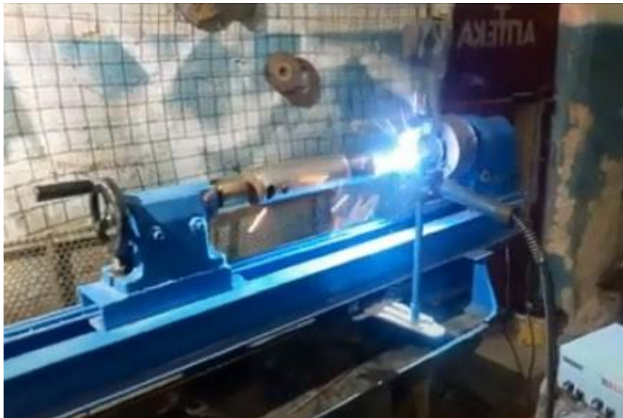
Рис. 3.3. Технологічний процес відновлення поверхонь із застосуванням мобільного наплавочного обладнання
